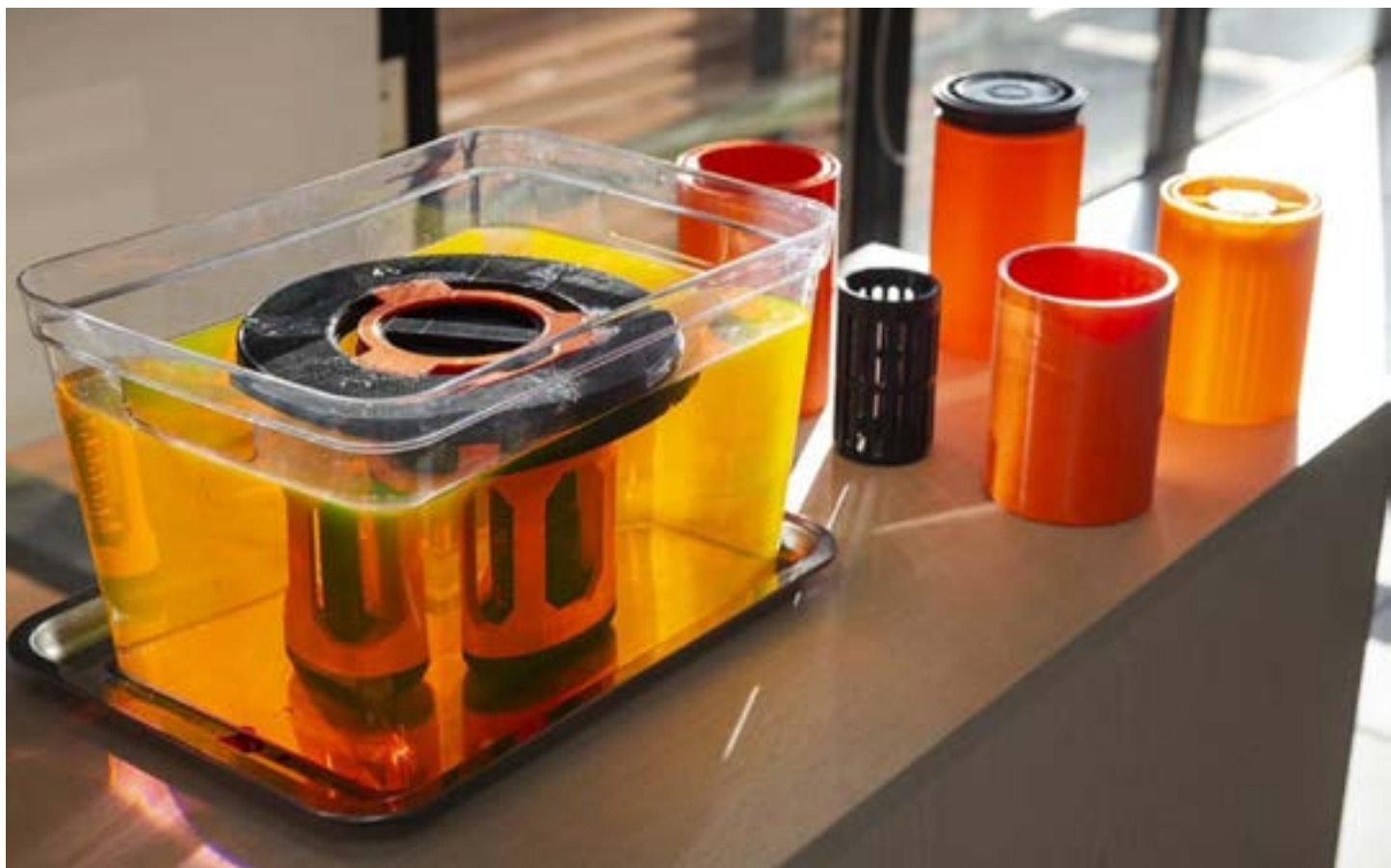
Filtro con biochar con capacidad de adsorción de colorantes y contaminantes.
