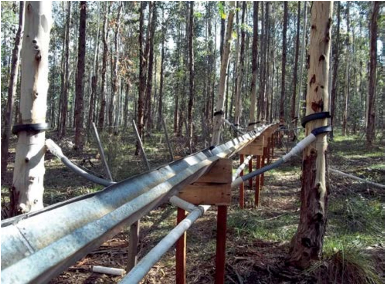
Parcela de medición de intercepción de la precipitación en la microcuenca Don Tomás en Paysandú.
